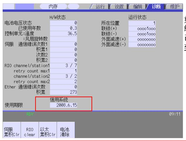
如果使用了信用系统,在"诊断"一"自己诊断"界面下能看到机床的使用期限。
